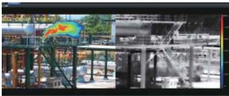
气云成像摄像机可以清楚地显示出碳氢化合物气体的释放及其浓度
