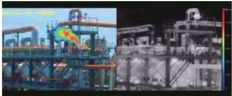
GCI摄像机可以清楚地显示出碳氢化合物气体的释放及其浓度
