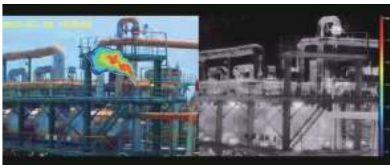
GCI摄像机可以清楚地显示出碳氢化合物气体的释放及其浓度
